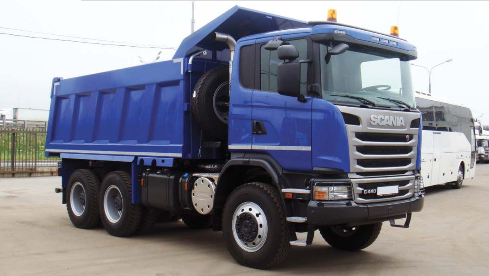
**Высокопроизводительный полноприводный самосвал SCANIA G440 CB6x6EHZ имеет грузоподъемность 25 тонн и предназначен для транспортировки скальных, вскрышных пород и других материалов с плотностью до 1600 кг/м<sup>3</sup> в разрезах, карьерах и по дорогам общего пользования. Загрузка предпочтительна гидравлическими экскаваторами или фронтальными колёсными погрузчиками с объёмом ковша 2 – 5 м<sup>3</sup>.**
